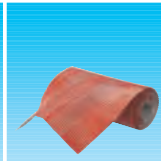
18 Alu-Trockenfirstband, gerippt, micro-perforiert, B 28 cm, in 5 m-Rollen, IQ ca. 157 cm 2 /lfm, passend zu Firstziegeln Nr. 1, 2, 3
