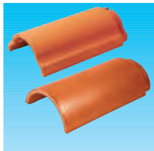
16 Firstziegel Nr. 2 (DL ca. 2,5 Stück/lfm., DB ca. 19,5 cm)
