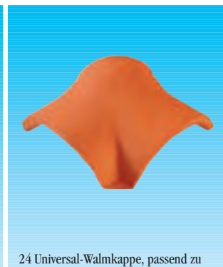
24 Universal-Walmkappe, passend zu Firstziegel Nr. 2 bzw. Nr. 3, 3-achsig. Verlegung bei ca. 12 - 45° Dachneigung, evtl. Anpassung nötig
