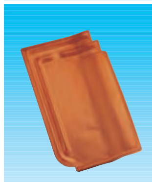
23 Universal-Walmkappe, passend zu Firstziegel Nr. 1, 3-achsig. Verlegung bei ca. 12 - 45° Dachneigung, evtl. Anpassung nötig
