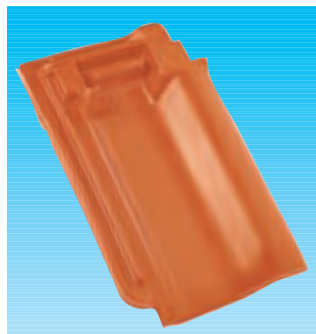
05 Firstanschluss-Schiebe-Entlüfter-Ziegel, Lattung ca. 10,0 - 30,0 cm, Lüftungsquerschnitt (LQ) ca. 10 cm 2 /Stück, DIN 4108/3
