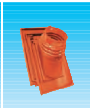
13 Thermenabgas-Durchgangspfanne, PVC, Ø 12,5 cm, ideal von ca. 16-40°
